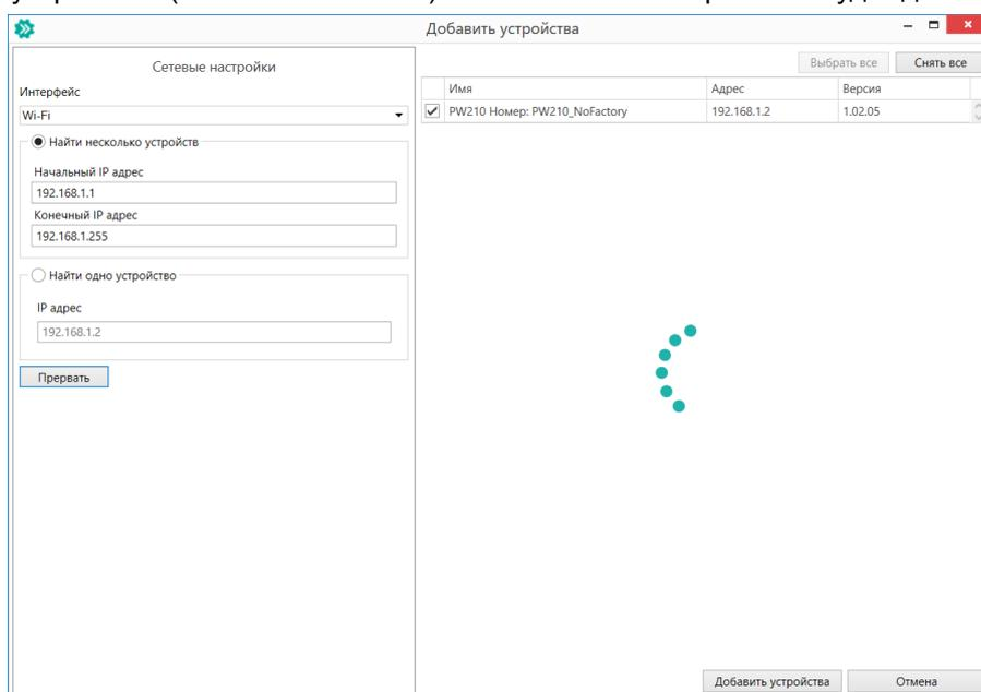
**Рисунок 8.6 – Добавление устройства**
