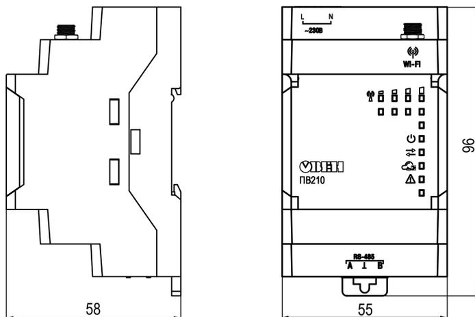
**Рисунок 5.1 – Габаритные размеры**
